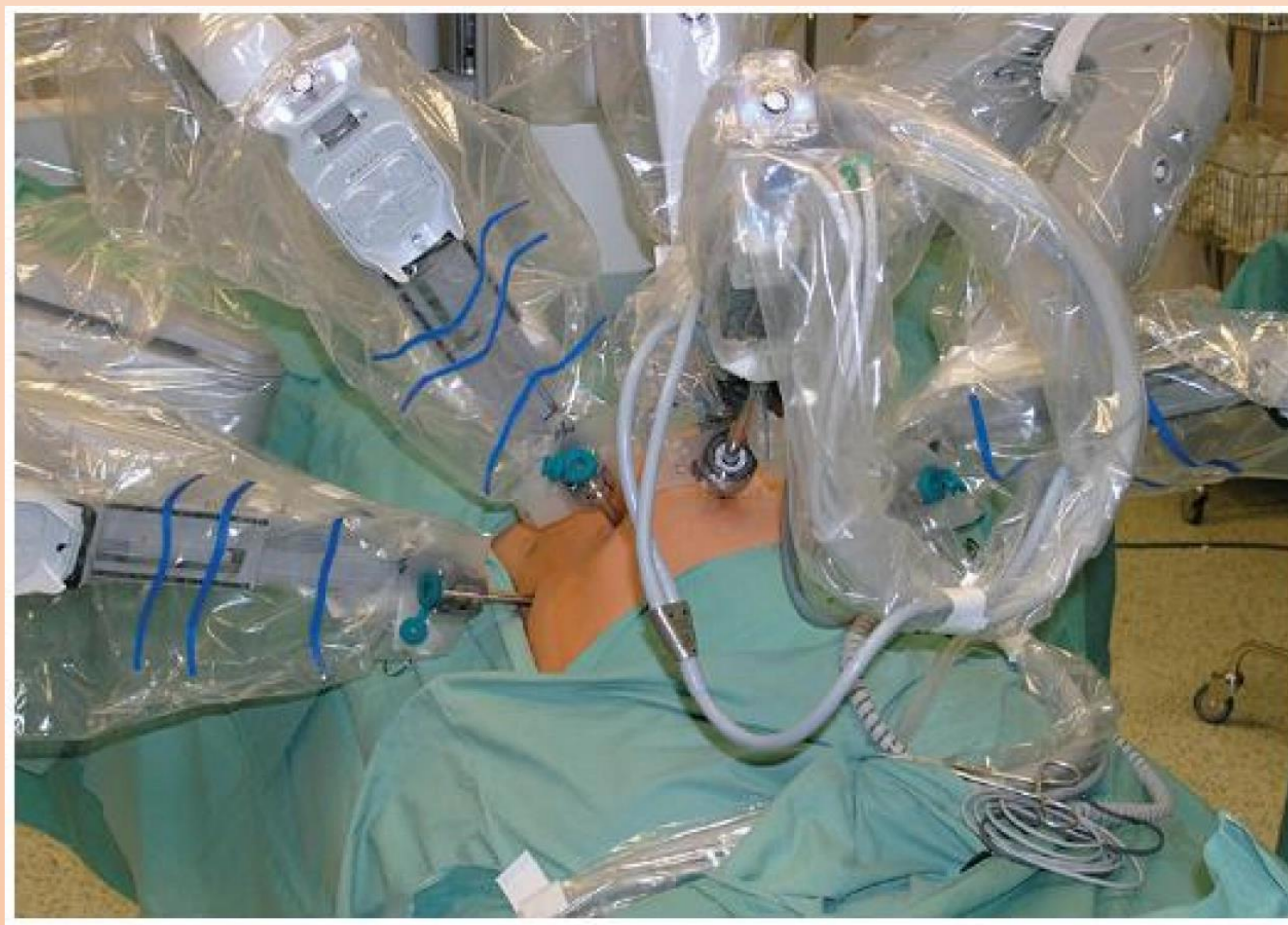
Obr. 1: Připevnění ramen robotického systému da Vinci S HD a Xi k zavedeným portům
